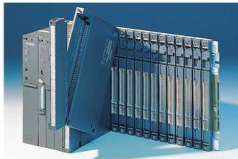
Рисунок 2.2 – Контроллер SIMATIC S7-400
