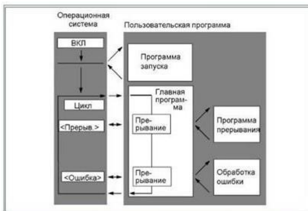
Рисунок 2.3 – Схема обработки программы с прерываниями
